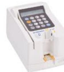
Анализатор биохимический на основе принципа «сухой химии» Spotchem EL (SE-1520) в комплекте с двойной пипеткой Twin Pipette
